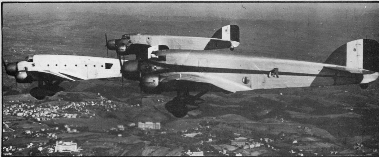
Un interessante immagine che mostra in primo piano il prototipo dello SM.81, in secondo piano un velivolo di serie ed in terzo piano uno della preserie, tutti con motori Piaggio. Notare le differenze nella vetratura e nel carrello. (Foto A.M.I.)
