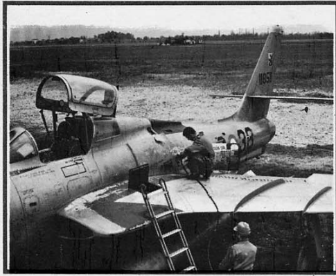
Specialisti al lavoro su un Republic RF-84F Thunderflash della 3ª Aerobrigata. Notare l'usura della vernice sull'ala ed il particolare degli aerofreni.
