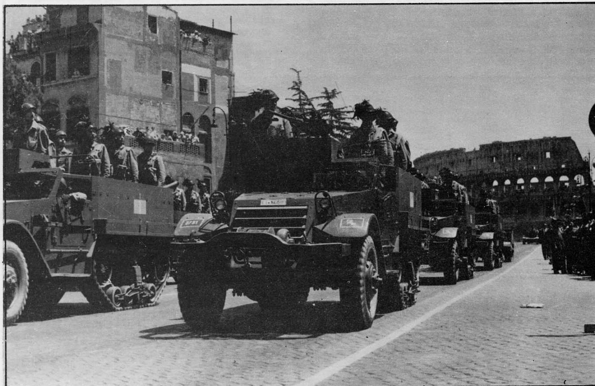
Halftrak della Divisione Centauro fotografati in occasione della sfilata del 2 Giugno probabilmente negli anni 1956-57. Notare i contrassegni di vecchio tipo e la particolare configurazione del parafrangente diverso da quello standard americano.
