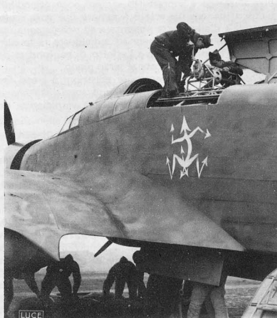
Vista parziale di uno Sparviero della 193ª Sq. che mostra la configurazione semplificata dell'"omino elettrico" senza motto e senza cerchio. Sono in corso le operazioni di carico delle bombe mediante l'apposito verricello che era di dotazione al velivolo e veniva montato sul dorso per l'occasione.
