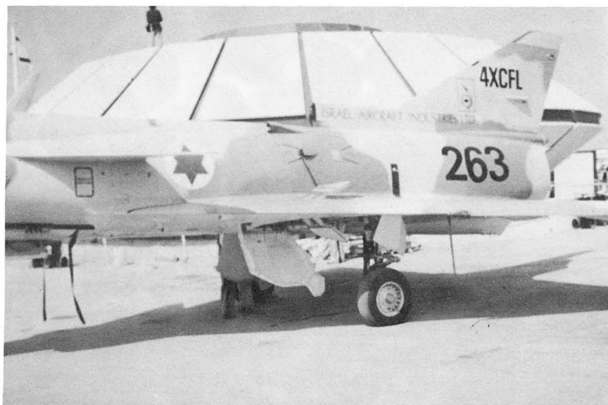
In questa bella immagine di 3/4 si possono osservare: il dettaglio della faccia interna dei portelli del carrello principale, la gamba dello stesso, la posizione dei vari stencils presenti in fusoliera e, a sinistra, la forma del paraflamma del cannone. (foto Benuzzi).
