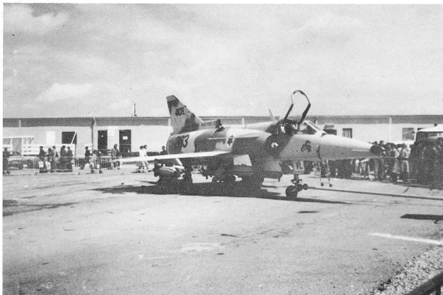
Sempre lo stesso velivolo ci mostra la posizione degli attacchi sotto alle prese d'aria principali. Le bombe appese alle rastrelliere sono in azzurro scuro, con la parte terminale, compresi gli impennaggi, in nero. (foto Benuzzi).
