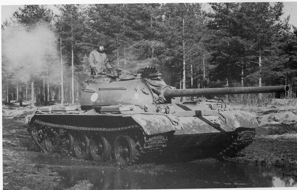
Un T-54 dell'Esercito Finlandese in movimento su terreno alquanto accidentato. Di particolare interesse sono i tubi, forse lanciarazzi, installati in torretta e probabilmente vincolati al sistema di brandeggio verticale dell'armamento principale. Per i patiti di araldica la targa è Ps 261-43, mentre una sorridente testa di Paperino indica certamente l'appartenenza ad un reparto, purtroppo non identificabile. (Esa Muikku, I.P.M.S.-Finlandia, via Armando Rossi, I.P.M.S.-Modena)
