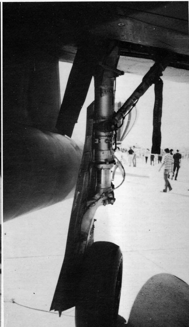
SOTTO - Due immagini del carrello di un F-105D. A sinistra la gamba anteriore, con in evidenza gli ammortizzatori antitorsione; in alto a destra è visibile lo sfogo per lo strato limite della presa d'aria sinistra. A destra la gamba principale sinistra vista da dietro; da notare il cavo del circuito pneumatico di comando del freno.
