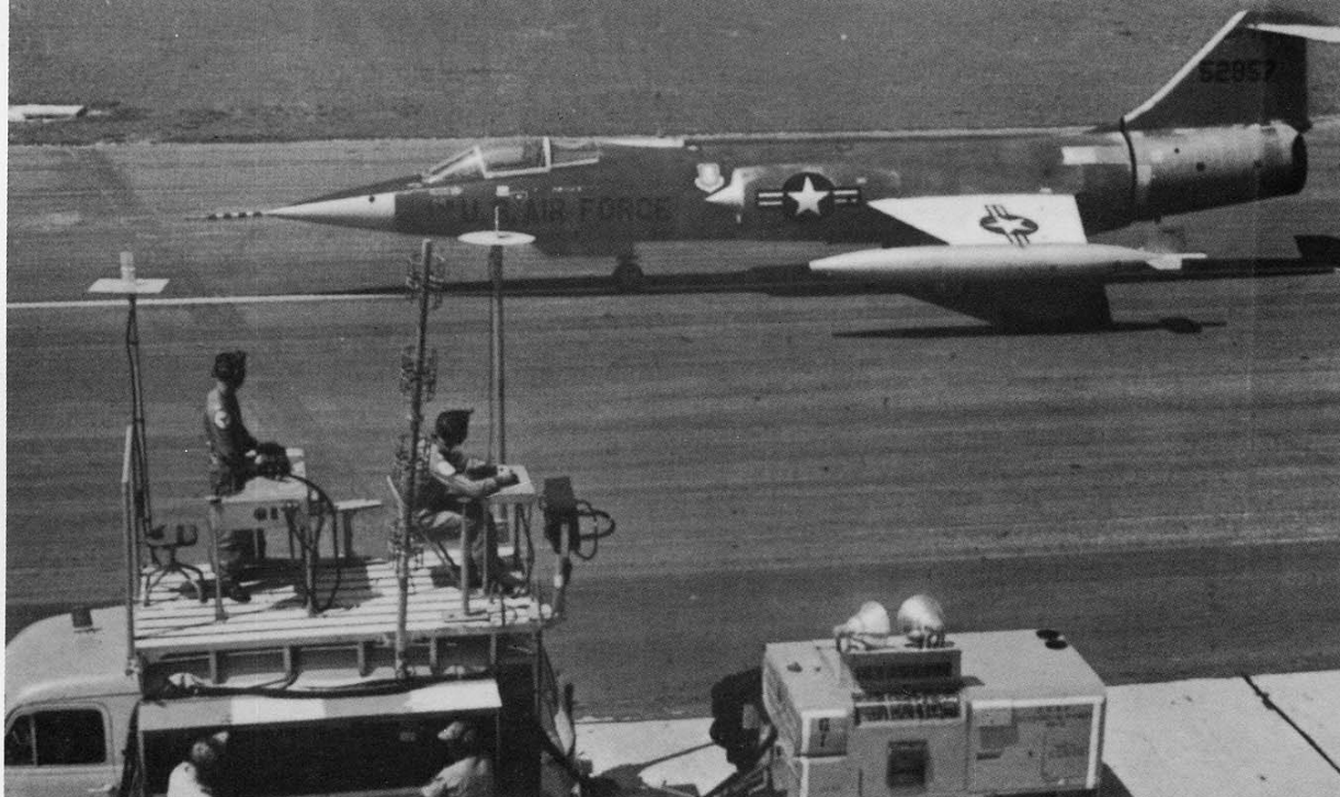
dettaglio tipico è il fuso nella parte posteriore del serbatoio d'estremità, contenente un'antenna del sistema di radioguida. In primo piano nella foto è il van di controllo, con il personale addetto al "pilotaggio" del caccia. (Sperry via C.S.A. Italy, AZ)
