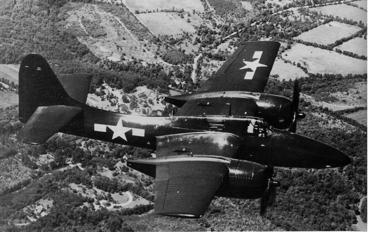
Una immagine di un F7F-2 Tigercat in volo: si tratta probabilmente dell'esemplare Bu.No.80261, ovvero del prototipo della versione -2 ricavato convertendo il terzo esemplare di serie di F7F-1. Particolarmente evidenti i depositi dei gas di scarico lasciati dagli scarichi posti nella parte superiore delle gondole motori. (foto Grumman via C.S.A.-Italy, G.Pini)
