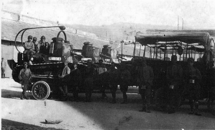
Caserma di Foligno 13/8/1926 - Un reparto di carristi al momento del rancio sosta vicino ai mezzi cingolati pronti a partire per una esercitazione, i carri armati Fiat 3000/21 sono stati caricati sugli appositi carrelli trainati da autocarri. Il primo blindato è probabilmente una versione radio. Qui la mimetizzazione è a tre colori disposti sul carro con macchie irregolari. (foto autore)
