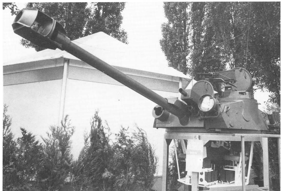
Sotto: Torre Lynx 90. Realizzata dalla ditta Hispano-Suiza. Armamento 1 cannone da 90 mm. DEFA D.921A o 1 cannone del medesimo calibro di tipo CK MK.3 ed una mitragliatrice coassiale da 7,62.
