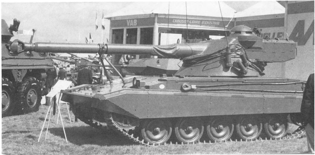
Sopra: Carro da combattimento AMX 13 realizzato dalla ditta Creusot Loire Industrie. Veicolo armato con un cannone da 105 mm con caricamento automatico.
