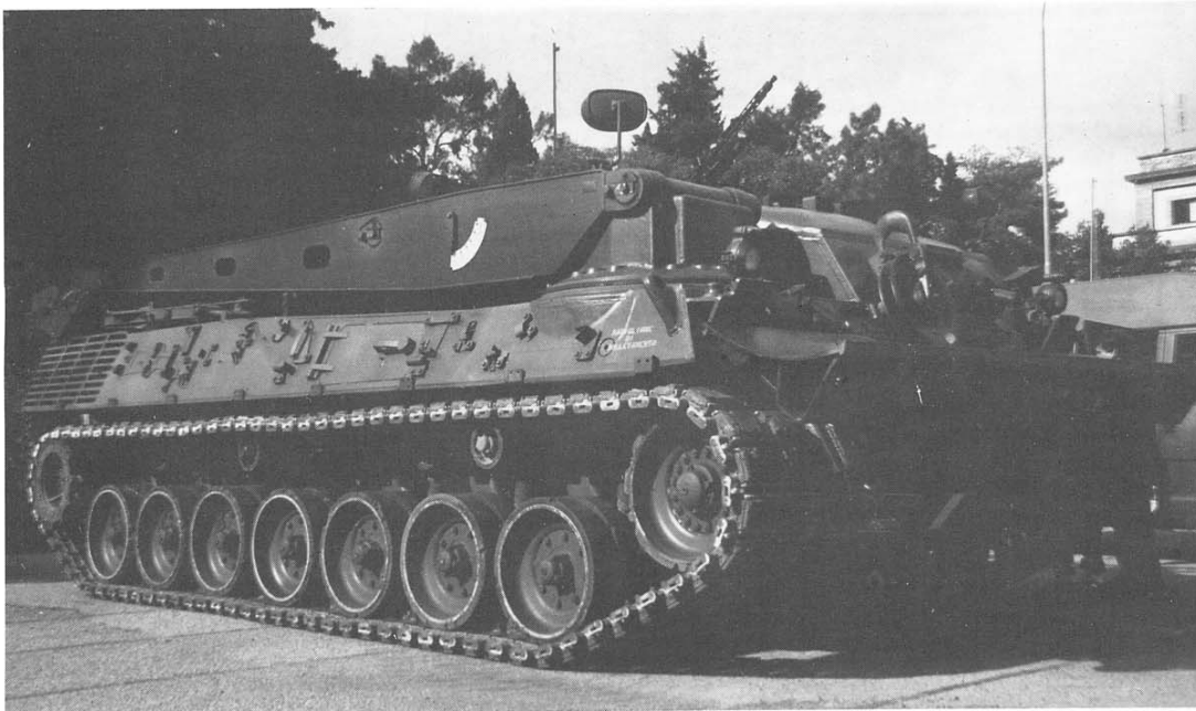
Bergerpanzer, veicolo corazzato su scafo Leopard in dotazione alle unità meccanizzate per il recupero ed il soccorso a mezzi corazzati danneggiati in combattimento o in avaria. (foto Autore).
