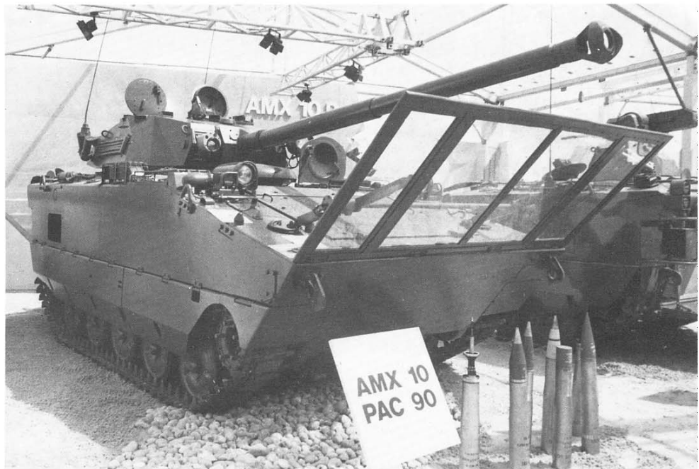
A Lato: AMX-10 PAC-90. Veicolo realizzato dalla ditta G.I.A.T. ed armato con 1 cannone da 90 mm. ed 1 mitragliatrice coassiale da 7,62 mm.
