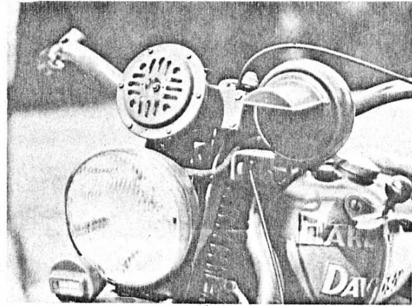
Vista particolare del fanale, clacson, fanalino oscuramento (sotto la visiera in nero opaco), fanalino posizione (finestrina bianca) e molle.
