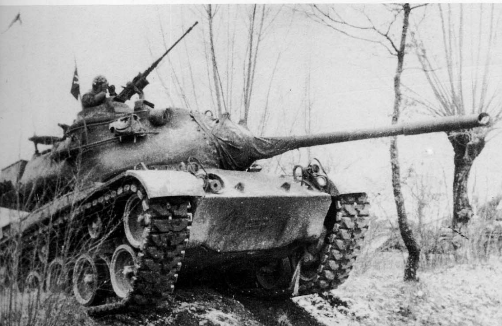
Un M-47 italiano durante una esercitazione svoltasi nel Friuli nel 1965. Si possono osservare diversi dettagli interessanti, come l'assenza della mitragliatrice di scafo e l'impianto di illuminazione esterna di nuovo tipo; il freno di bocca è del tipo a "T" standardizzato su tutti i mezzi in servizio nel nostro Esercito. Altra particolarità è la presenza di carichi esterni (due zainetti) fissati sul fianco della torre, cosa assai inusuale per i nostri carri. Da notare anche il tromboncino spegnifiamma all'estremità della canna della mitragliatrice contraerea sul cielo della torre, ed i cingoli del tipo interamente in gomma. (V. Zoboli)
