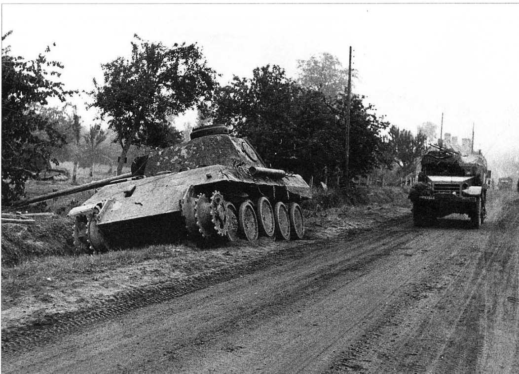
Un veterano ancora in azione: un Panther Ausf D di produzione intermedia, probabilmente appartenente alla 2ª SS Panzer Division, distrutto in Normandia nel luglio 1944; il carro ha la vecchia cupola e le aperture in torretta per le armi individuali, ma manca del portello laterale per il munizionamento. (foto Imperial War Museum)
