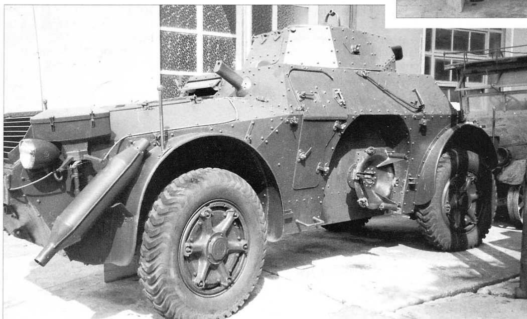
Qui a lato: Un'Autoblinda AB 43, versione ferroviaria, che venne largamente utilizzata dalle truppe tedesche, specie nei reparti esploranti delle Divisioni di Fanteria, ma senza troppa soddisfazione. È ufficialmente conosciuta in Italia come AB 41/43, per evitare confusione con il prototipo della AB 43 dotata di cannone da 47/40. (foto arch. R.Cignini) In alto: Vista posteriore dello stesso mezzo, utilizzato nel dopoguerra dal Genio Ferroviario Italiano. (foto arch. M.Pieri)
