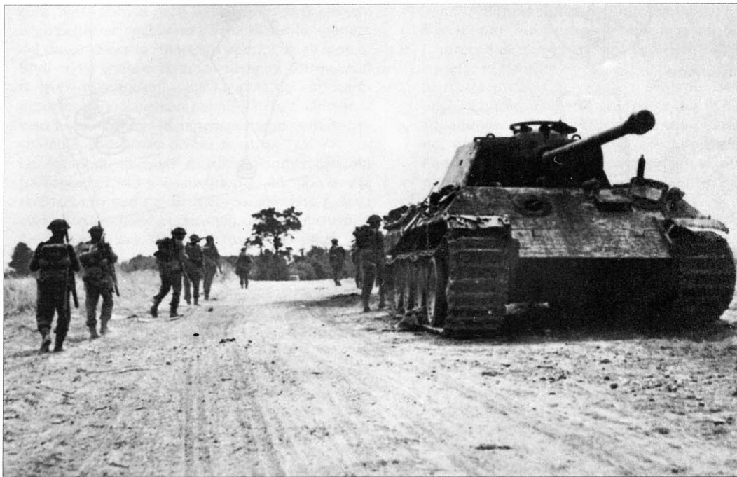
Qui a lato: Questo Panther distrutto in Francia nell'estate del 1944 è invece un normale Ausf A; l'apertura che si intravede sul lato della torretta è stata provocata da un proiettile perforante. (foto National Archives Canada)
