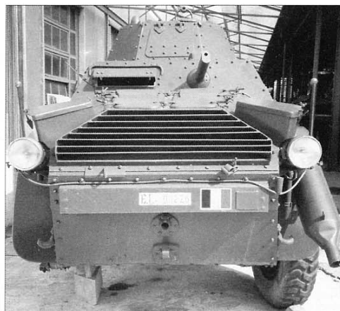
Qui a lato: Un'Autoblinda AB 43, versione ferroviaria, che venne largamente utilizzata dalle truppe tedesche, specie nei reparti esploranti delle Divisioni di Fanteria, ma senza troppa soddisfazione. È ufficialmente conosciuta in Italia come AB 41/43, per evitare confusione con il prototipo della AB 43 dotata di cannone da 47/40. (foto arch. R.Cignini) In alto: Vista posteriore dello stesso mezzo, utilizzato nel dopoguerra dal Genio Ferroviario Italiano. (foto arch. M.Pieri)
