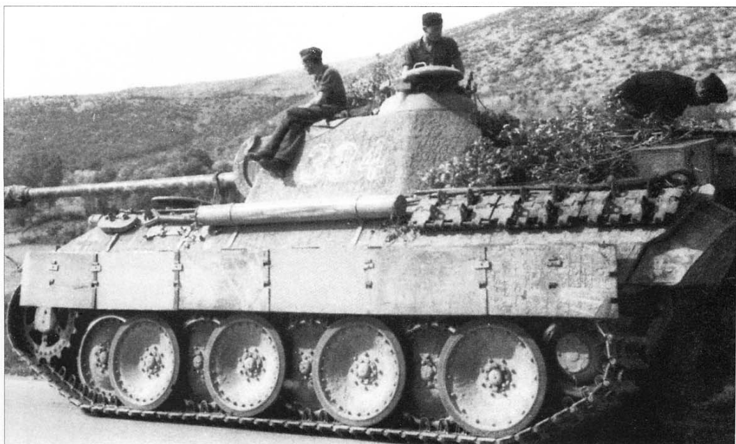
Qui a lato un Panther Ausf D di produzione tarda, in Italia, estate 1944. Il carro porta la numerazione standard a tre cifre, rosse con bordi bianchi, in torretta e la croce sul bordo anteriore dello scafo, ma stranamente è verniciato nel solo color giallo-sabbia di fabbrica ad eccezione della lunga canna del cannone, mimetizzata in tre colori; ha rulli sia a 16 che a 24 bulloni; questo carro ha due Schürzen non originali, dato che una è di materiale zigrinato e un'altra ha la Zimmerit ed è in posizione rovesciata. (foto D.Guglielmi)
