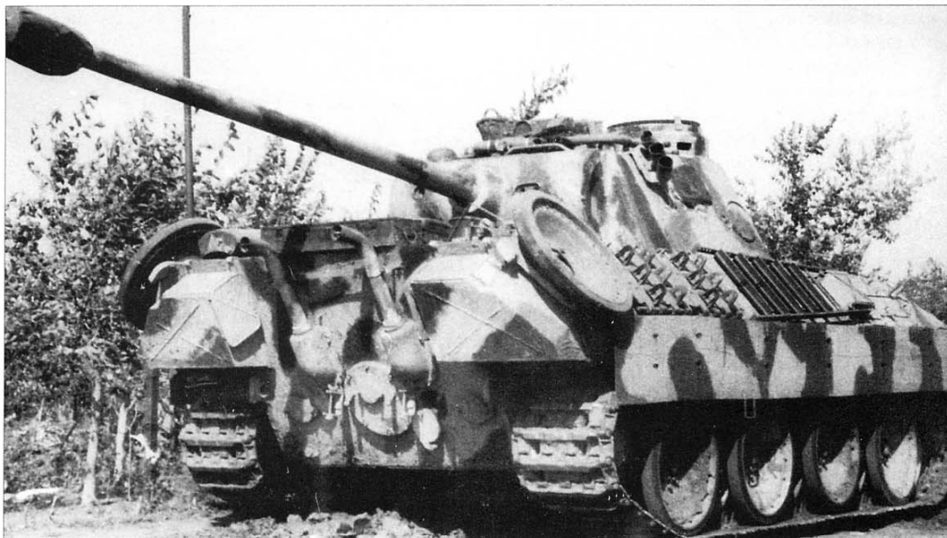
Un Panther Ausf D in addestramento in Francia nel 1943; i rulli sono a 16 bulloni ma quello di scorta ne ha 32, la colorazione è giallo-sabbia e verde-medio; notare la Zimmerit stesa grossolanamente e anche sugli Schürzen, i lanciagranate, i listelli orizzontali sui fori degli scarichi motore, la grondaia sul visore binoculare del tiratore, le piastre anti-calore nella parte interna dei portaoggetti posteriori, i cingoli senza ramponi e il portellino per l'avviamento a manovella, sotto lo scarico destro, aperto. (foto D.Guglielmi)
