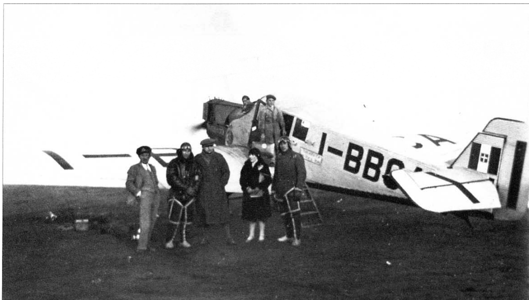
Qui ritratto in partenza un Fokker F 13 della Transadriatica (marche I-BBCA) usato sulla tratta Venezia-Brindisi; differisce dalla versione presa in esame in quest'articolo per la forma degli equilibratori e soprattutto della deriva verticale. (foto coll. C. Pecchi)
