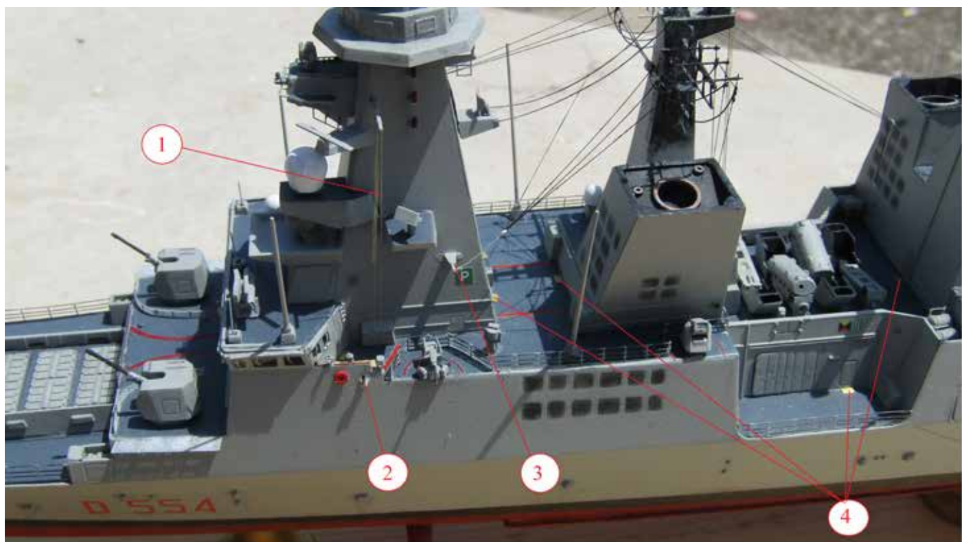
1) Aggiunto sagolino bandiere di segnalazione; 2) Aggiunta luce di posizione lato sinistro; 3) Aggiunta piccola varea per ancoraggio linea aerea prodiera lato di sinistra; 4) Aggiunti zerbini di ottone alla base di ogni portello.
